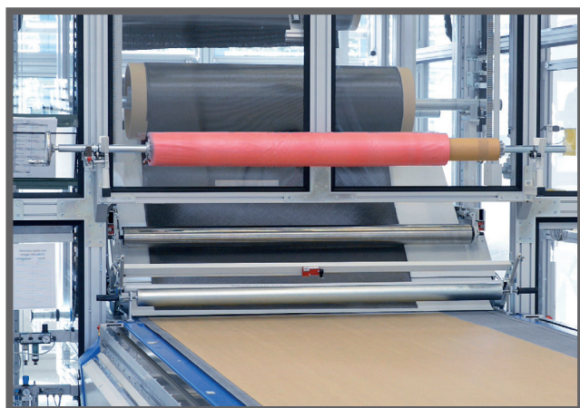
Vista: unità del dispositivo di svolgimento
