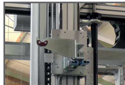
- Dispositivo di passaggio e prelievo dei rulli di materiale
