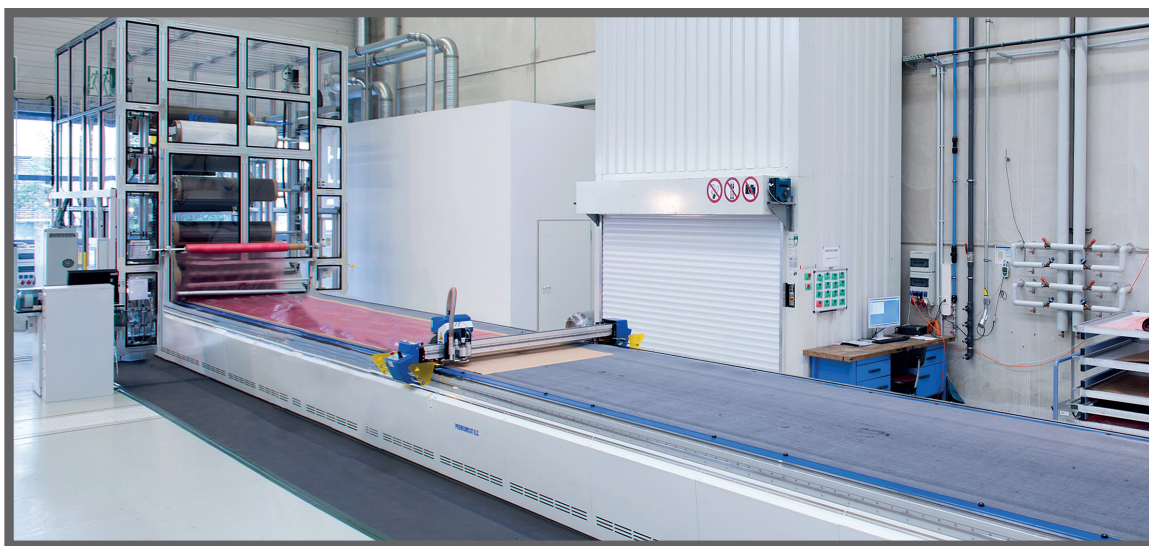
Dispositivo di svolgimento installato a monte di un cutter
